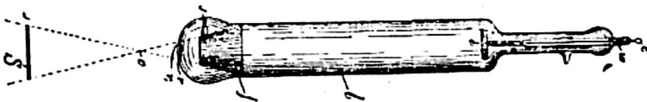
Nikola Tesla egyelektródás reflexiós kúppal ellátott röntgensöve
